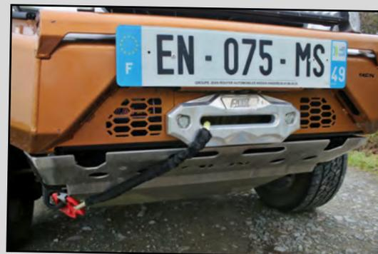
Caché dans le pare-chocs avant, ce Navara dispose d'un treuil Djebel Xtreme 5,4 tonnes contrôlable via soit une télécommande radio soit une filaire.
