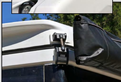
Pour être sûr qu'il soit parfaitement plaqué au hard-top, le toit relevable est maintenu fermé par ces quatre pattes réglables.
