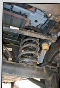
Afin de compenser le poids de l'aménagement intérieur, cette JLU repose sur des ressorts OME +300 kg à l'arrière.
