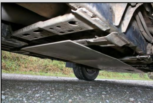
À la suite du mini ski avant AFN 4x4, ce Nissan à benne se pare de blindages Djebel Xtreme en aluminium de 8 mm d'épaisseur.
