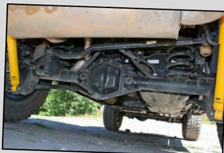
Mécaniquement, cette JLU reste quasiment d'origine. Elle repose juste sur un kit suspension OME + 40 mm.
