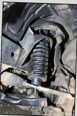
Afin de gagner 40 mm en hauteur, la suspension de ce Nissan a été confiée à un kit suspension EFS comprenant des ressorts HD (avant et arrière) associés à des amortisseurs XTR.
