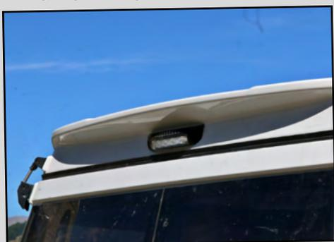
Pour y voir clair la nuit, cet éclairage à leds prend place en hauteur sur la face arrière du toit relevable.
