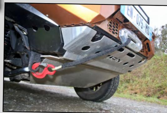
Afin de protéger correctement l'avant du véhicule en cas de chocs, le pare-chocs avant AFN 4x4 intègre un mini ski en aluminium.
