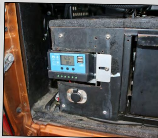
Grâce à ce régulateur Djebel Xtreme, Richard connaît en permanence le voltage de la batterie auxiliaire... mais il peut surtout la recharger via un panneau solaire pliable de 120 Watts.
