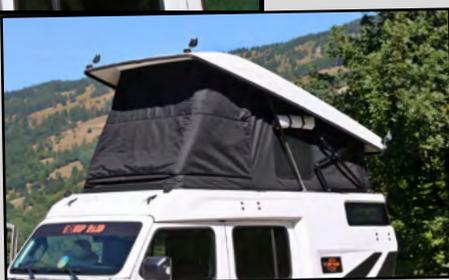
Pour ne souffrir ni de la chaleur ni du froid, la toile du toit relevable est un modèle triple épaisseur.
