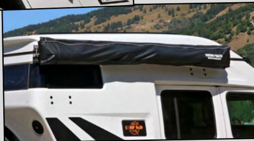
Pour manger à l'ombre, la Jeep Feet Run de Benoit s'habille d'un auvent 270° Rhino Rack sur son côté droit. À signaler que, de série, le Life Spirit dispose des pas de vis pour un montage à gauche aussi.
