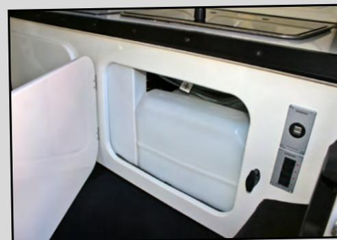
Dissimulée sous l'évier, vous trouvez une réserve d'eau de 42 litres. À signaler qu'un réservoir de 19 litres pour les eaux usées prend place sous le plancher.
